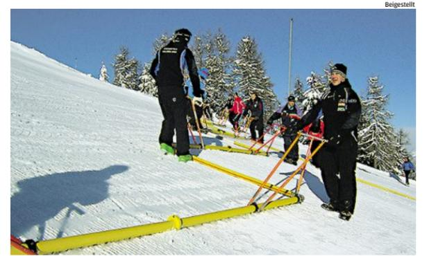
Spezialmaschinen aus Tirol: **Injektionsspritzbalken** fürs Verdichten und Härten der Skipisten
