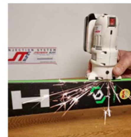
Vario-Kanten-Schleifmaschine für ultimative scharfe Kante.
