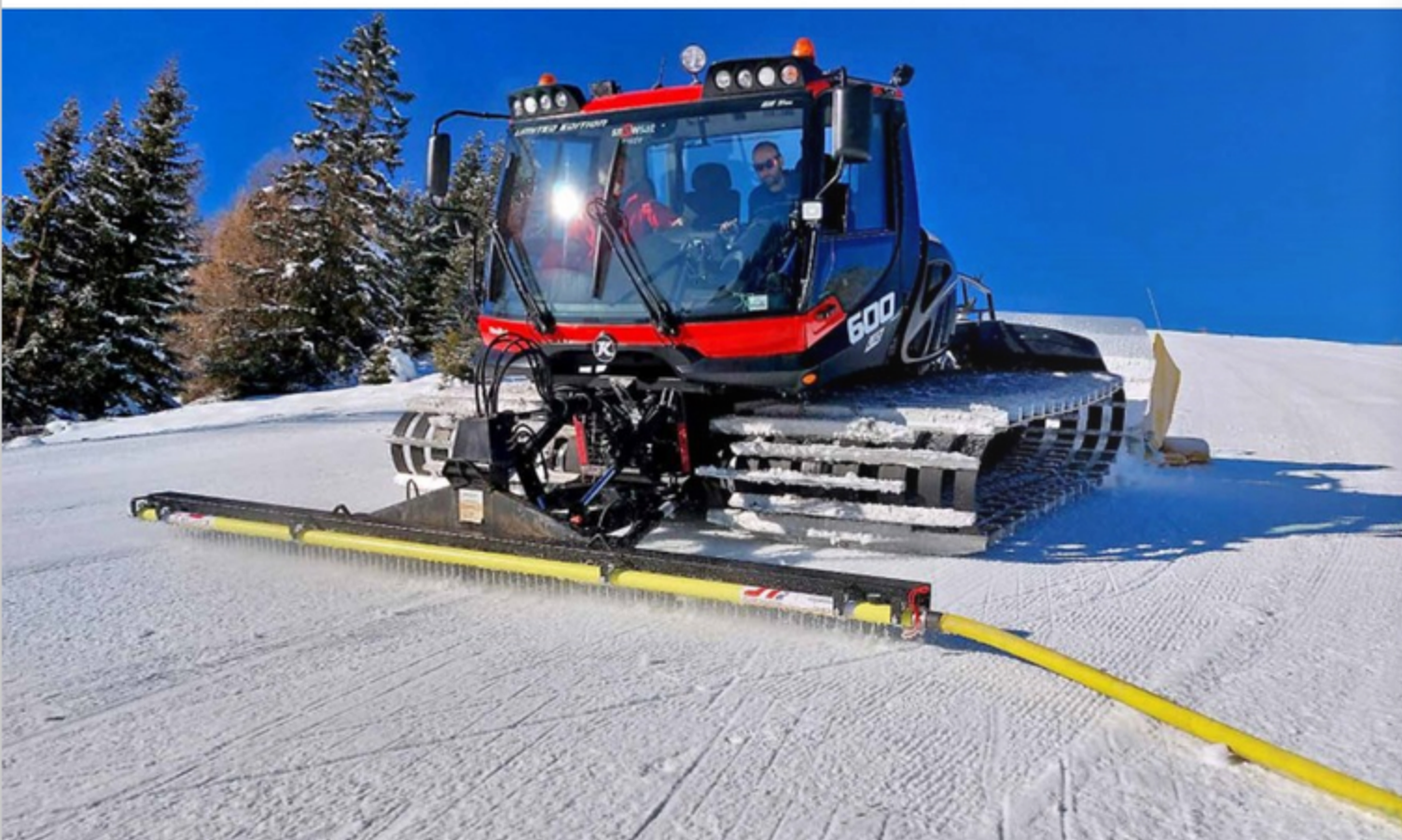
Neue Generation Injektionssprühbalken an der Pistenmaschine mit exakter Dosierbarkeit der Wassermenge aus der Fahrzeugkabine.
