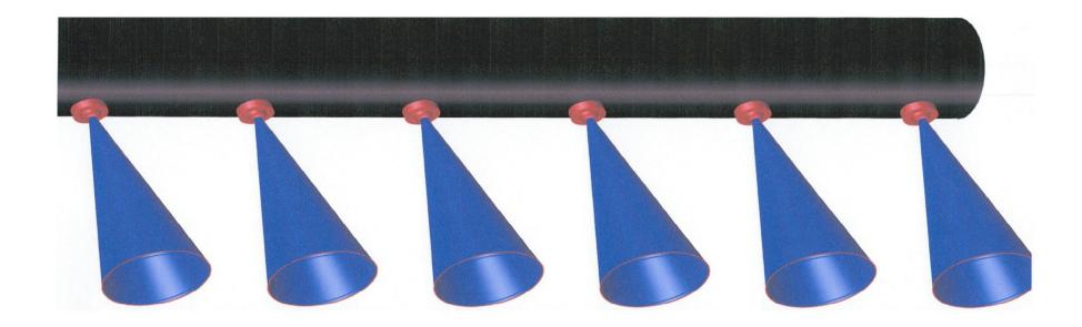
Durch spezielle Rotations-Düsen wird das Wasser in den Schnee injiziert und breitet sich kegelförmig aus. Durch den Kapillareffekt werden alle Schneekristalle mit Wasser benetzt. Dadurch entsteht eine sehr große Oberfläche über die die Verdunstungskälte die Schneedecke von oben nach unten abkühlt, so dass am unteren Kegelbereich die Piste die größte Härte aufweist. Dadurch kann eine lang anhaltende hohe Pistenqualität gewährleistet werden.
